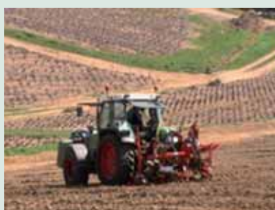
Machine à planter guidée par laser
